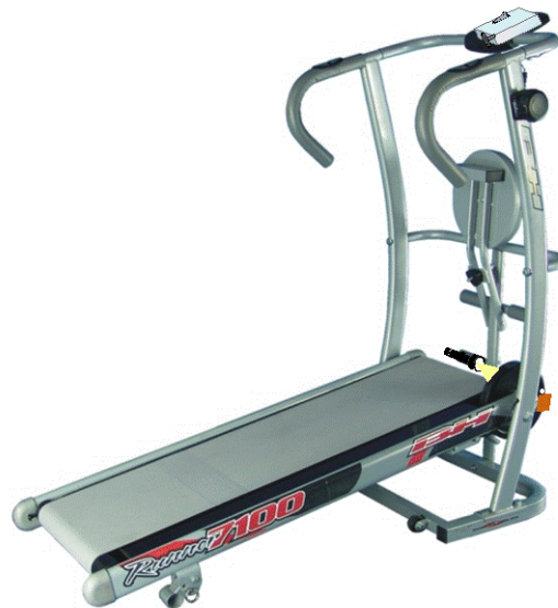
Figura 4 Prototipo de camino sin fin con ubicación de sensores vertical y horizontal.
