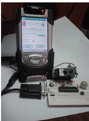
Figura 5 Interfaz para los servomotores en tiempo de diseño y en ejecución.
