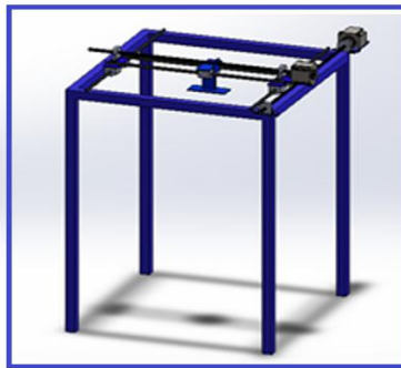
Figura 4. Diseño de Robot Cartesiano en SolidWorks
