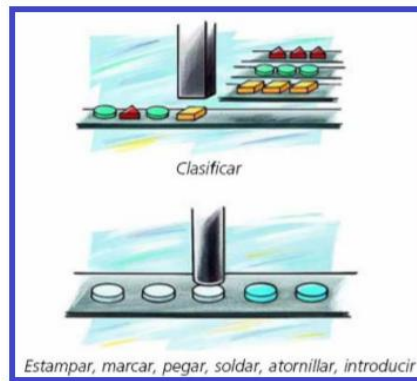
Figura 2. Ejemplos de Tareas de un Robot Cartesiano
