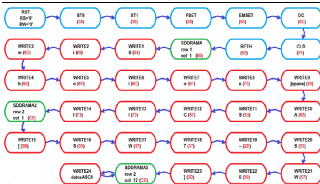
Figura 6. Diagrama de estados de la FSM para codificación ASCII.
