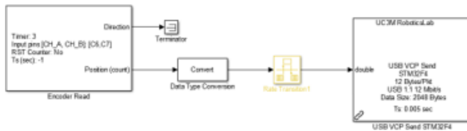
Figura 2 Diagrama para lectura de Encoder del motor y transmisión al VCP para posterior lectura en segundo programa
