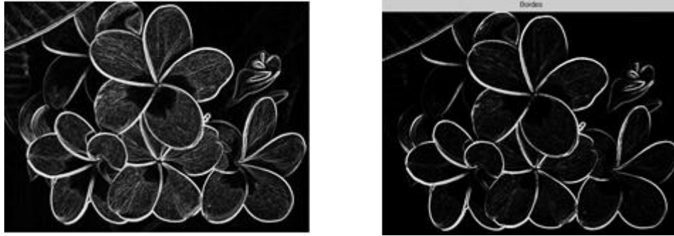
Figura 5. Del lado izquierdo, los bordes detectados en la imagen original en escala de grises después de aplicar el operador de Sobel únicamente. Del lado derecho los bordes detectados después de aplicar la teoría de Dempster-Shafer
