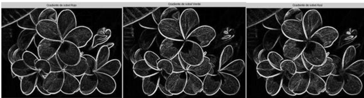
Figura 4. Gradiente de Sobel para las matrices R, G y B respectivamente (de izquierda a derecha)
