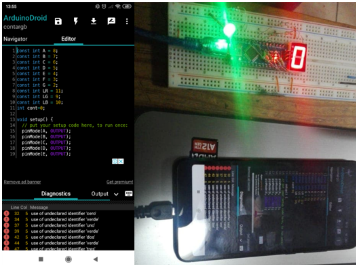
Figura 1. Contador hexadecimal de 0 a F.
