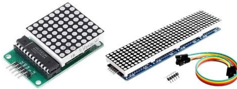
Figura 3. Tipos de arreglos y controlador de display matricial en PCB.
