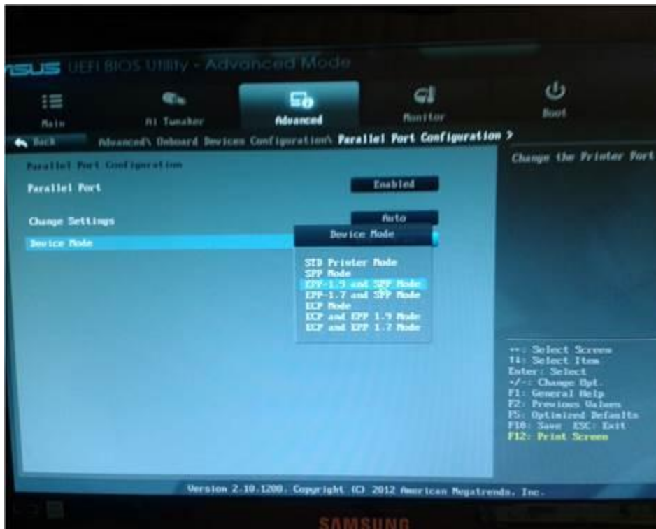
Figura 2. El modo por defecto que trae la computadora utilizada es "STD Printer Mode". Se cambió por "EPP-1.9 and SPP Mode"
