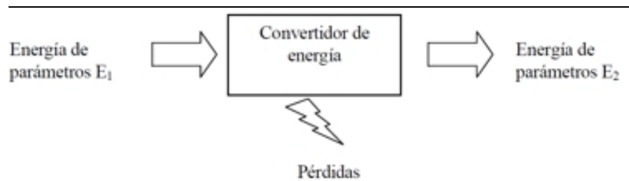
Figura 1.1 Diagrama general de un convertidor electrónico de potencia.
