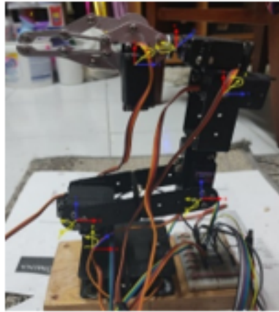
Figura 2. Ubicación de los ejes coordenados en cada unión.
