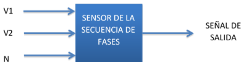
Figura 2.- Representación a bloques del circuito sensor del relevador
