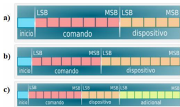
Figura 5 Codificación de datos en protocolo SIRC.
