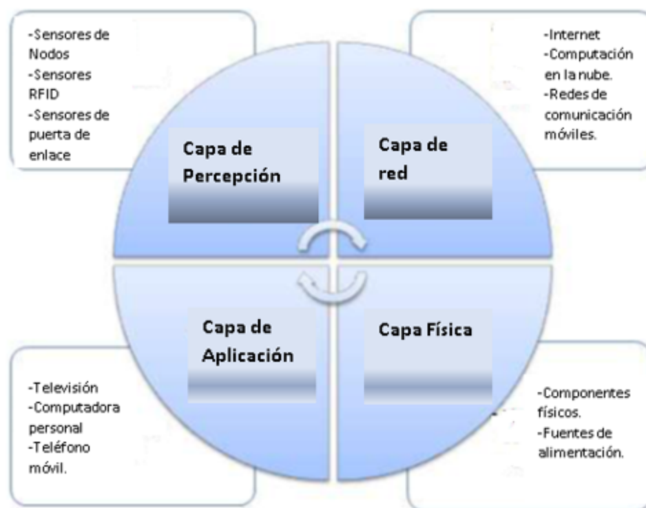
Figura 1. Capas IoT con sus respectivas capas.
