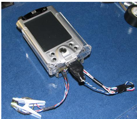
Figura 8 Vista final del prototipo del oxímetro portátil controlado por PDA.
