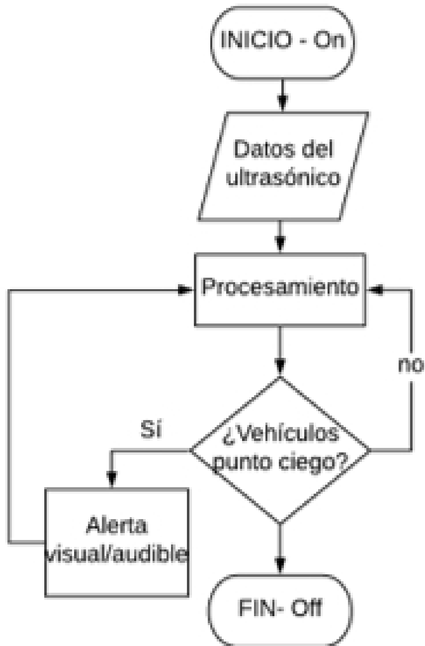
Figura 1. Diagrama de flujo del sistema de monitoreo de punto ciego.
