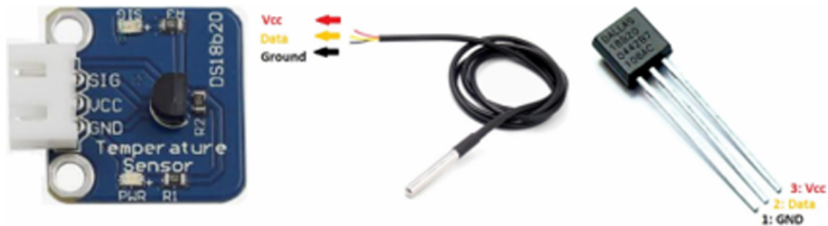
Figura 1 Sensor en placa, en sonda y discreto.
