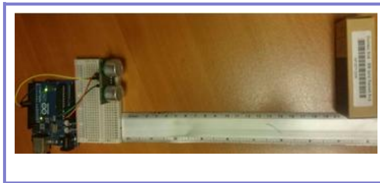
Figura 4. Objeto a una distancia de 20 cm del sensor ultrasónico.
