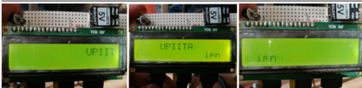
Figura 8. Fotos de las pruebas de la marquesina.
