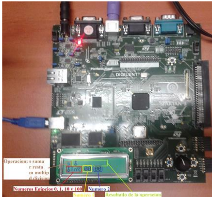
Imagen 1: LCD en funcionamiento con descripción de lo que representa cada sección
