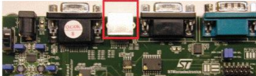
Figura 1: Localización y señales del conector PS/2
