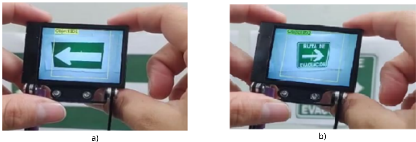
Figura 5 HuskyLens: a) Identificación sentido izquierdo y b) Identificación sentido derecho.
