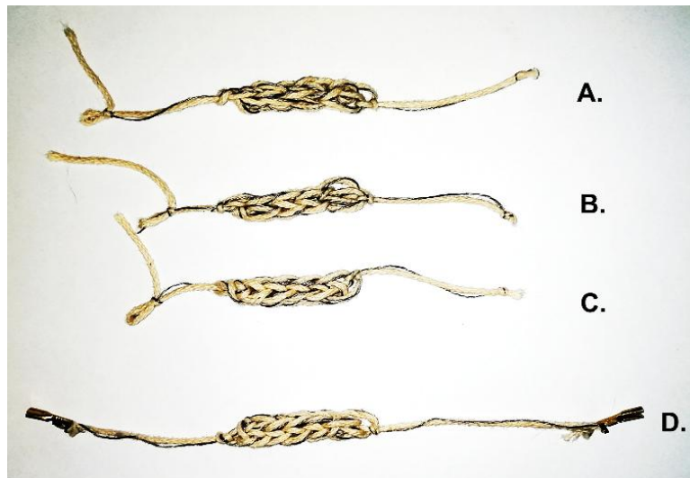
Figura 10. Los sensores tejidos a mano con el telar de 4 clavos se miden para determinar si existe una diferencia entre los valores de su resistencia.
