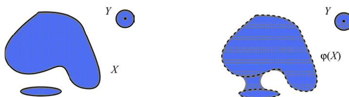
Figura 5 Cierre morfológico del conjunto X por el elemento estructurante Y . El cierre redondea las concavidades importantes. (a) señal unidimensional; (b) objeto 2D.
