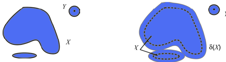
Figura 3 Dilatación de X por el elemento estructurante Y . El conjunto X aumenta su definición. (a) original; (b) resultado.
