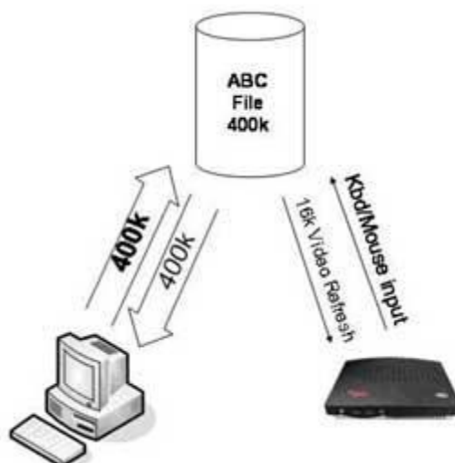
Figura 3. Arquitectura de funcionamiento de una Terminal ligera.
