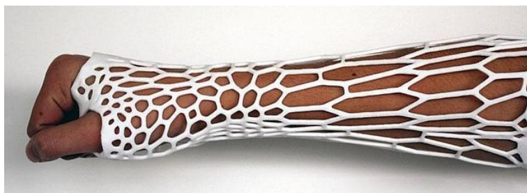
Figura 2. Escayola fabricada con técnicas de impresión 3D [5].
