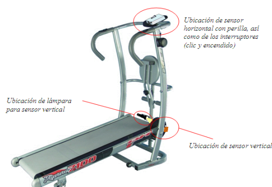
Figura 5 Sistema completo de la caminadora con conexión PS/2.
